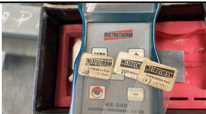
Foto 10: Calibração do aparelho de medição de camadas
