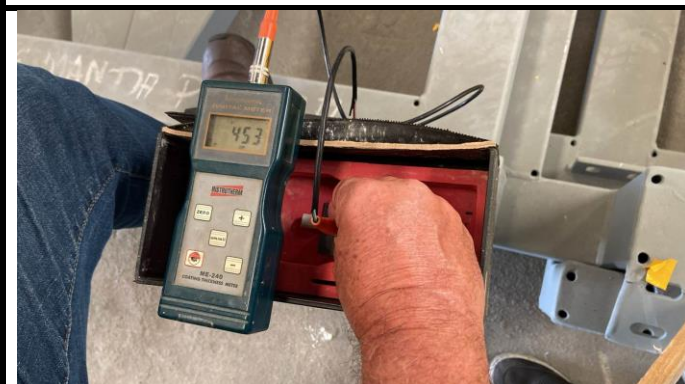
Foto 9: Calibração do aparelho de medição de camadas
