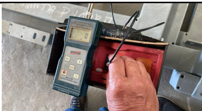
Foto 8: Calibração do aparelho de medição de camadas
