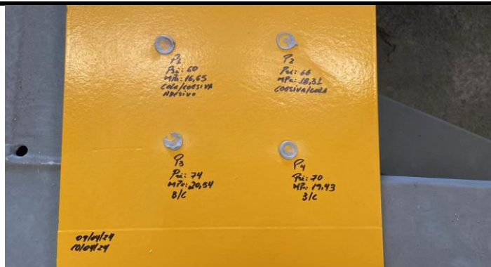
Foto 18: Resultado do ensaio de PULL-OFF
